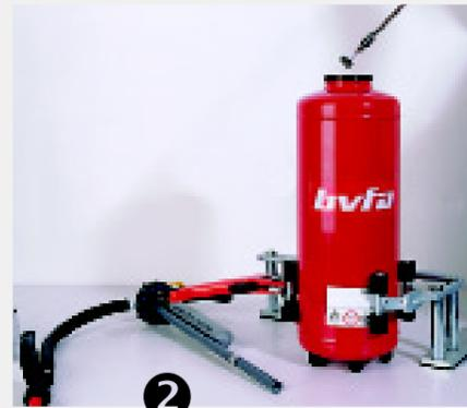
**2** Löschmittelbehälter vollständig entleeren. Feuerlöschmittel kontrollieren (Identität, Beschaffenheit, Weiterverwendbarkeit, Menge usw.), erforderlichenfalls erneuern.
