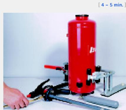
**3** Löschmittelbehälter innen und außen auf sicherheitsrelevante Beschädigungen und Mängel (Beulen u. Dellen, Korrosion, Gewindefschäden usw.) überprüfen. Armatur reinigen und demontieren, anschließend untersuchen (Gewindefschäden, Risse, Druckentlastungseinrichtungen usw.).
