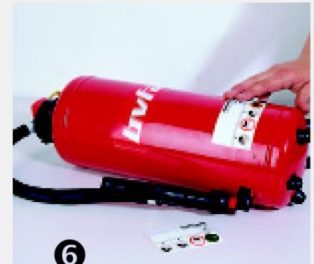
**6** Funktionsbereitschaft des Feuerlöschers wiederherstellen. Hierzu Feuerlöschmittel einfüllen, Armatur einsetzen, Feuerlöschер verschließen und sichern, Schlauch montieren. Instandhaltungsnachweis anbringen. Feuerlöschерhalterung kontrollieren.
