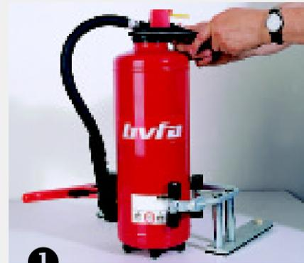
**1** Allgemeinen Zustand, Sauberkeit und Beschriftung des Feuerlöschers kontrollieren. Schlauch demontieren, Behälter öffnen und Armatur abschrauben.
